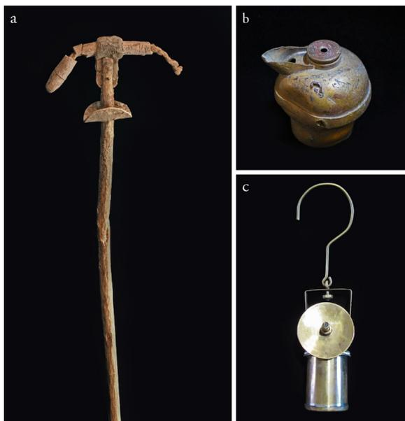
Figura 4. Dispositivos de iluminación utilizados por los pirquineros durante su labor: (a) candela o vela en soporte de palo; (b) lámpara de parafina o «pato»; (c) lámpara de carburo. Museo Regional de Atacama, Colección Socavón, n.º inv. 16.01, 98.138, 18.46. Fotografías de Ivo Regodeceves, Rodrigo Zalaquett y Constanza San Juan.
