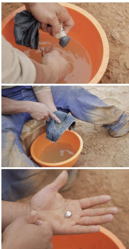
Figura 6. Proceso de estrujado del oro. Arriba, colocada al interior de un trozo de tela, la mezcla de oro y mercurio obtenida de la molienda se aprieta para dejar salir el segundo a través del tejido; al centro, partículas de oro rezagadas en la mezclilla luego de filtrarse el mercurio; abajo, bola de concentrado de oro o «peya» resultante del proceso. Fotografías de Ivo Regodeceves.
