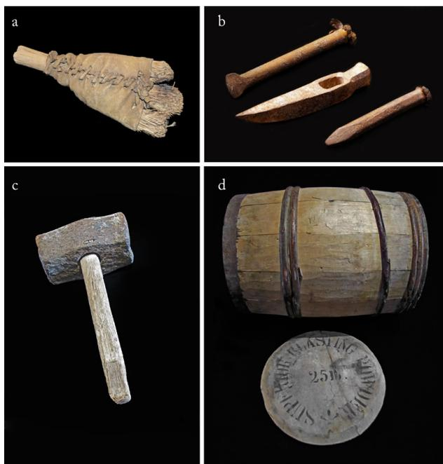
Figura 3. Herramientas y utensilios empleados por los pirquineros: (a) escobilla de madera, cuero y paja; (b) de arriba a abajo, barreno, picota y cuña; (c) «macho» de piedra y palo; y (d) barril de pólvora. Museo Regional de Atacama, Colección Socavón, n.º inv. 18.35, 01.212, 01.209, 01.204, 98.143 y 01.208. Fotografías de Constanza San Juan, Ivo Regodeceves y Rodrigo Zalaquett.
